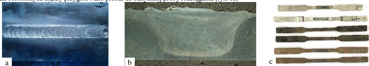
Rys. 1. Wykonane złącza stopu WE43 zgrzewane metodą FSW: a) lico połączenia, b) makrostruktura złącza, c) próbki po obróbce cieplnej do statycznej próby rozciągania
