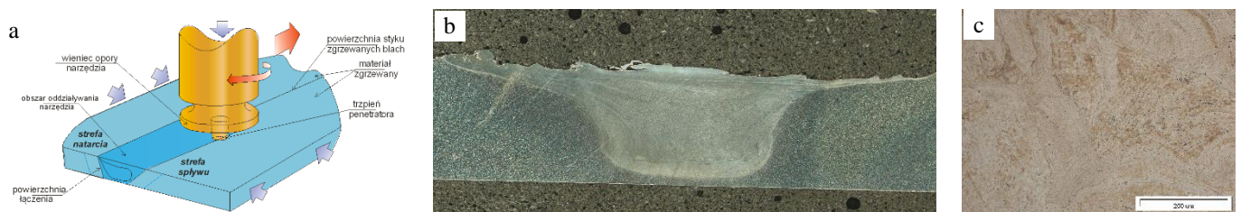
Rys. 1. Zgrzewanie stopu WE43 metodą FSW: a) schemat procesu zgrzewania FSW, b) makrostruktura złącza zgrzewanego ze stopu WE43 bez obróbki cieplnej, c) mikrostruktura złącza po przesycaniu i starzeniu (obróbka T6)
